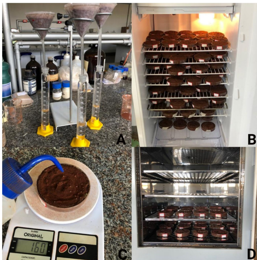
Figura 1 – Preparo do experimento. A – Determinação da capacidade de campo (EMBRAPA, 2009); B – Incubação das tratamentos; C – Restabelecimento da capacidade de campo diariamente; D – Retirada das amostras da BOD para determinação dos parâmetros avaliados.
