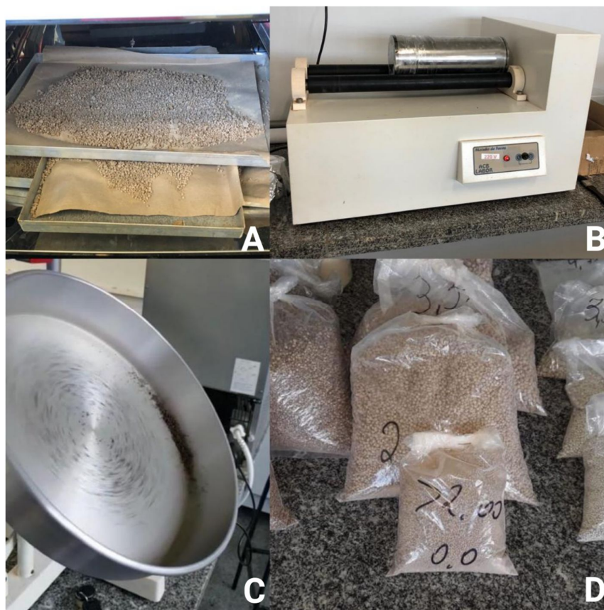
Figura 2 – Preparação dos fertilizantes organominerais. A – Secagem da cama aviária em estufa; B – Trituração das partículas da cama aviária em moinho de bolas; C – Granulação do fertilizante organomineral; D – Separação dos grânulos.
